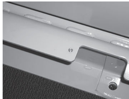
Figure 2 : Pénétration adéquate de la peinture
