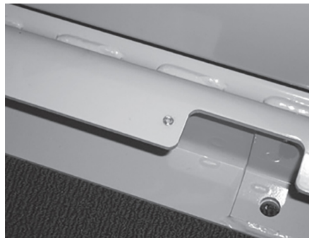
Figure 2 : Pénétration adéquate de la peinture
