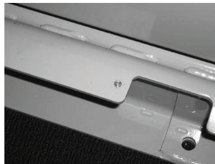
Figure 2 : Pénétration adéquate de la peinture
